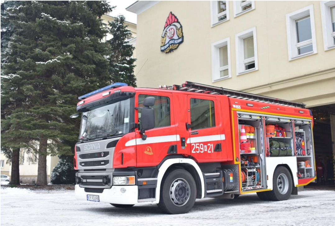
Rys. 11.2. Samochód gaśniczy, wodno – pianowy z funkcją ratownictwa technicznego, pierwszowyjazdowy – GBART 2/24 Scania.
