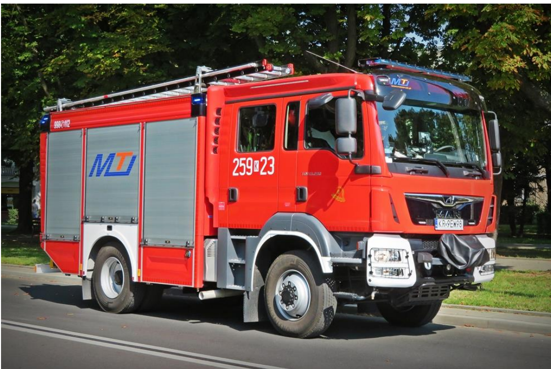
Rys. 11.3. Samochód gaśniczy, wodno – pianowy z funkcją ratownictwa technicznego – GBART 2,9/16 Man.
