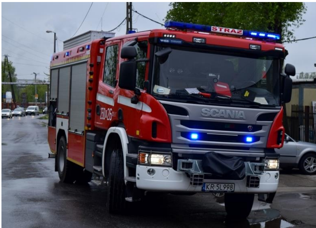
Rys. 11.4. Samochód gaśniczy, wodno – pianowy z funkcją ratownictwa technicznego – GCBART 5/32 Scania.
